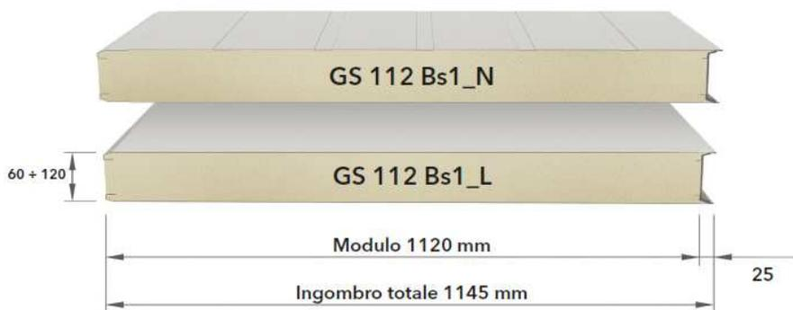
Pannelli sandwich ad incastro maschio femmina prodotti su pressa in continuo, in conformità alla Norma Europea EN 14509, adatti alla realizzazione di celle frigorifere a temperatura positiva e negativa, Marcate CE in conformità al benessere tecnico europeo ETA 10/0001. I pannelli Bigsystem della gamma GS 112, sono studiati per elevate prestazioni di isolamento termico, resistenza meccanica, estetica, igienicità, rapidità di montaggio.
